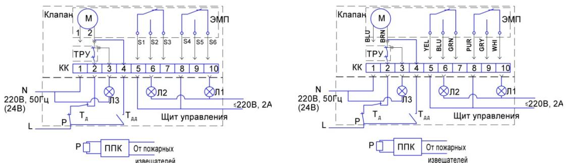
ЭМП - электромеханический привод; Л1, Л2, Л3 - лампы световой сигнализации; Тд - тумблер дистанционного управления; Тдд - тумблер дистанционного управления после пожара при наличии ТРУ; ТРУ - терморазмыкающее устройство (опция); ППК - прибор приемно-контрольный; Р - реле.
