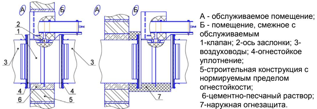
Рис. 4. Схемы установки клапана
