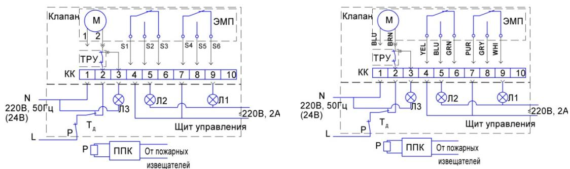
ЭМП - электромеханический привод; Л1, Л2, Л3 - лампы световой сигнализации; Т - тумблер дистанционного управления; ТРУ - терморазмыкающее устройство (опция); ППК - прибор приемно-контрольный; Р - реле .
