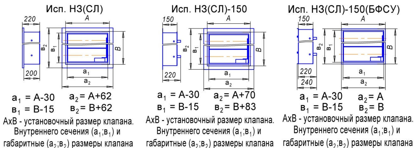
Рис.1. Установочные, габаритные и размеры внутреннего сечения клапана.
